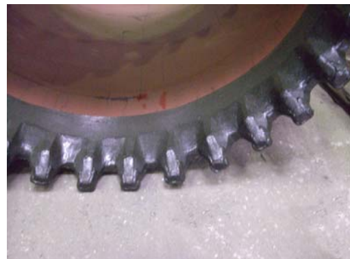
ベント刃先状況
